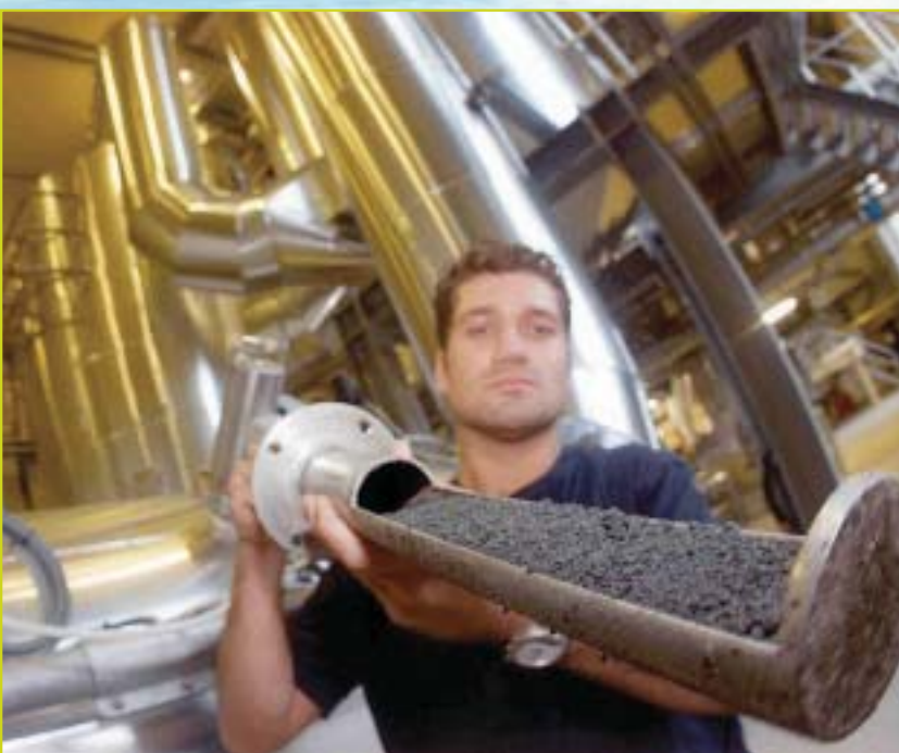
• Het zuiveringsslib wordt verwerkt tot droge korrels (Foto: Ermindo Armino)
