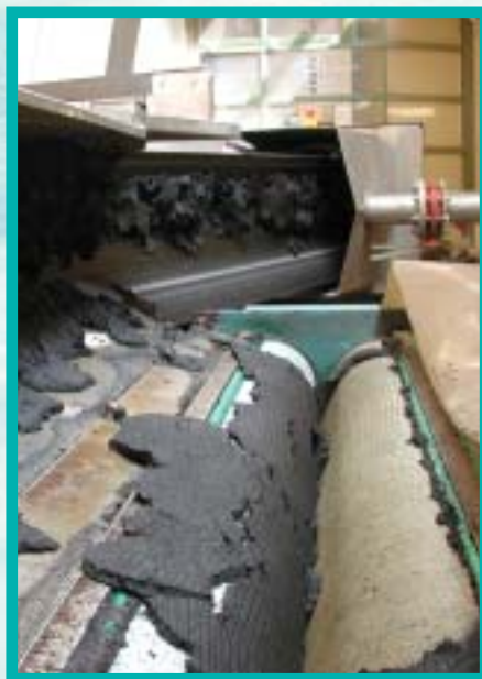
• Het ontwaterde zuiveringslib rolt van de zeefbandpers.
